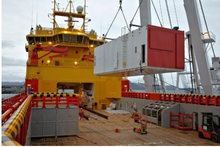
Şekil 2.7 : Viking Lady gemisi yakıt pilleri montajı (Tronstad ve diğ, 2017).
