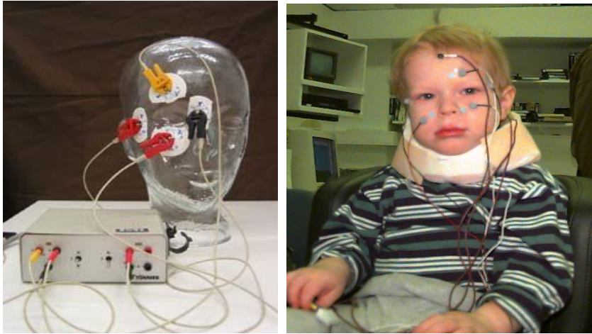
Resim 1.14: EOG ölçüm düzeni ve EOG elektrodu
