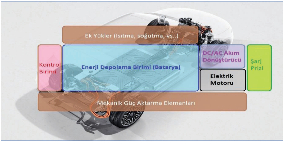
Şekil 3. Elektrikli Otomobillerde Hareket Sisteminin Ana Parçaları
